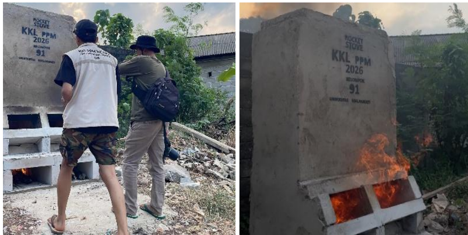
Gambar 7. Uji Coba Penggunaan Rocket Stove Dengan Sampah Rumah Tangga
